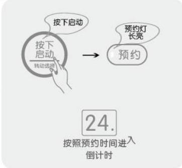
**4** 倒计时到预约时间完成后，预约指示灯熄灭，机器进入工作状态至烹饪结束。
