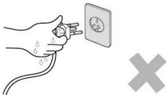
❗ 不可用湿手插、拔插头，以免触电。拔下插头时，必须握住插头柄，不能拉扯电源线，否则易损伤电源线。
