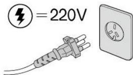
❗ 请单独使用额定电流为10A及以上，交流电压为220V的电源插座，以免引起火灾、触电等事故。
