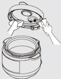
**4** 清洗保养完毕后请再次确认防堵件、密封圈、限压放气阀等已正确安装。
