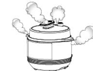
！ 搬移产品时，请端提手或煲体底部隐藏把手，切勿直接提上盖手柄，以免上盖与煲体脱离，产品落下造成人身伤害。
