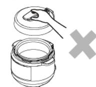
！ 清洗内胆时，请使用海绵或软质材料布擦洗。请勿使用钢丝球、铁铲等硬质器具刮洗，防止划伤内胆表面。
