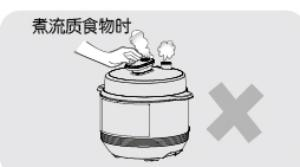
**2** 煮不含流质食物时，开盖前先按住把手上的排气按钮，进行排气，排气时请勿靠近排气盖，以免烫伤，待安全眼落下后，方可开盖。
