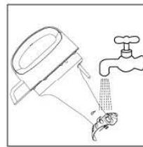
**2** 清洗超微精磨器：请用清洁刷仔细清洗超微精磨器，注意一定要用清水冲洗干净，以免残留饮品残渣产生异味。
