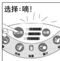
按功能键选择相应功能程序，每次选择机器伴有“嘀”一声提示音，对应功能指示灯（或图形指示灯）亮，机器自动启动相应的制作程序，机器伴有“滴滴”两声提示音，提示程序已启动。
